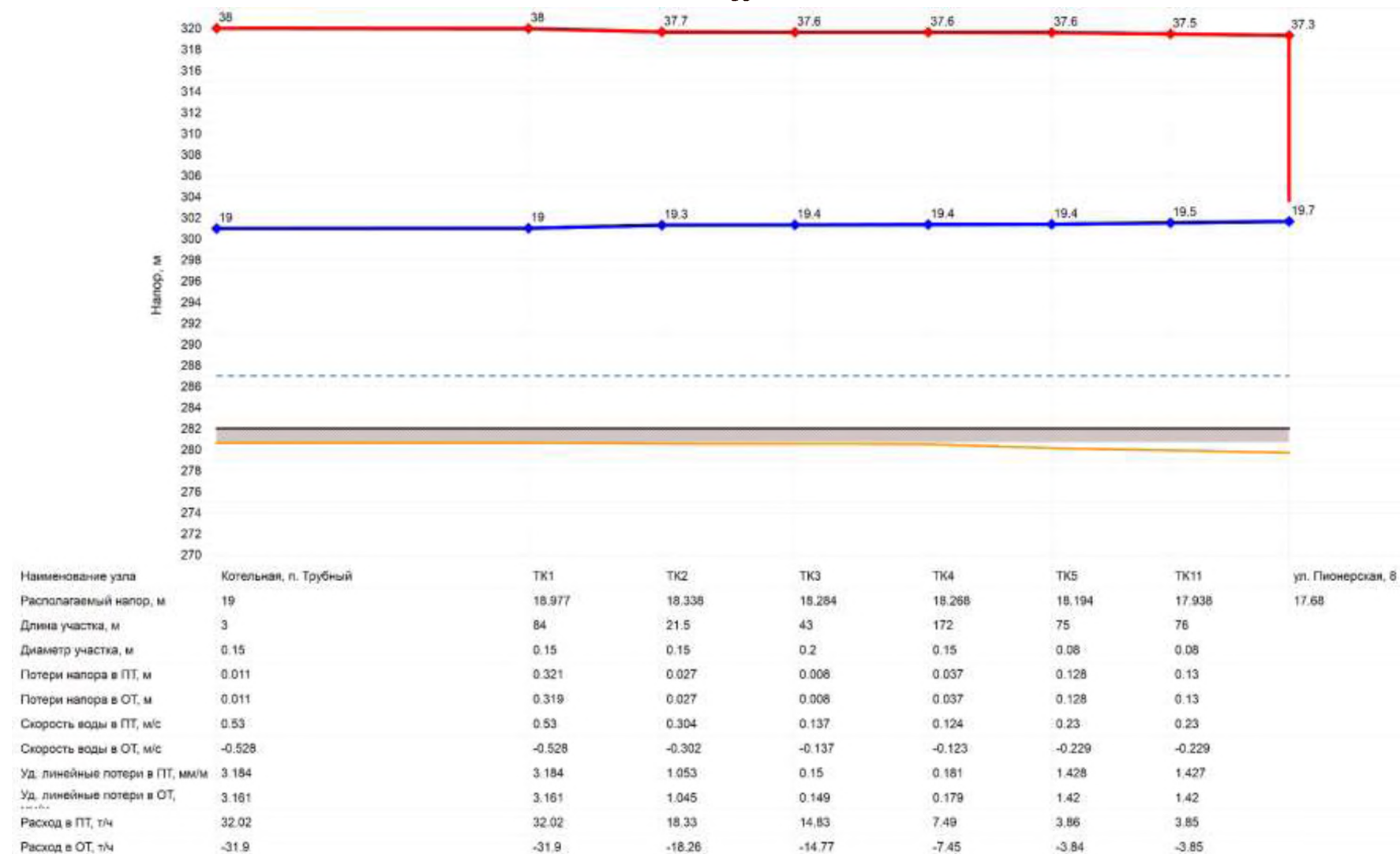
Рисунок 1.3.8.3. Пьезометрический график от Котельной, п. Трубный, ул. Верхняя, 19 до ул. Пионерская, 8
