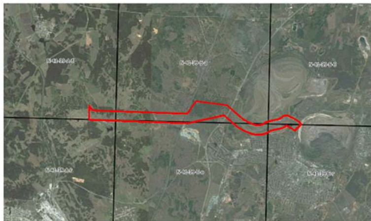
Рисунок 4.5 – Разбивка трассы при аэрофотосъёмке по планшетам в масштабе 1:25 000
