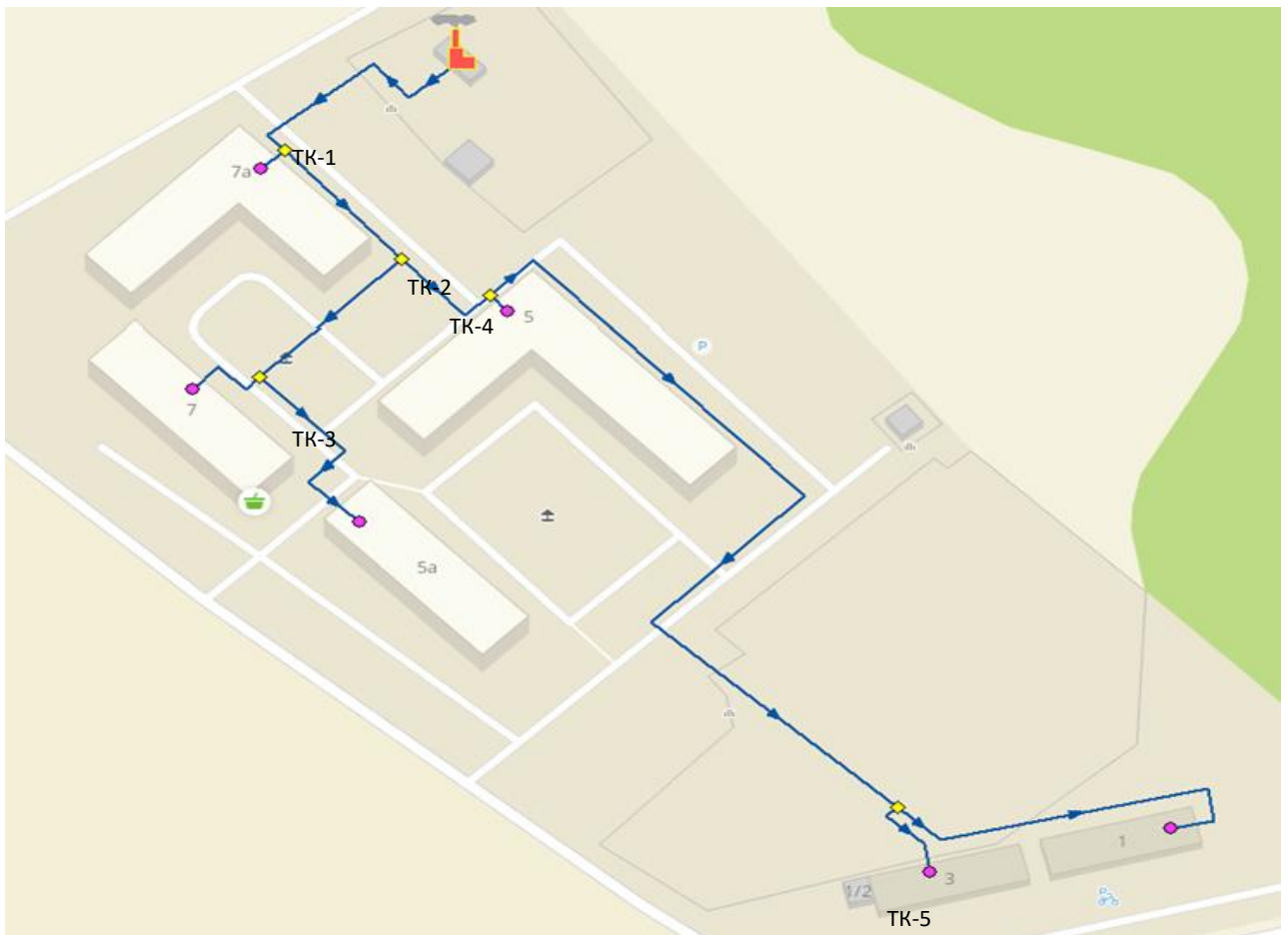
Рисунок 4-3. Схема тепловых сетей в контуре котельной «мкр. Кленовый» с обозначением тепловых камер
