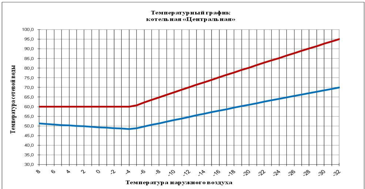
Рис. 2.7.2 – 1 Предлагаемый температурный график котельная «Центральная»
