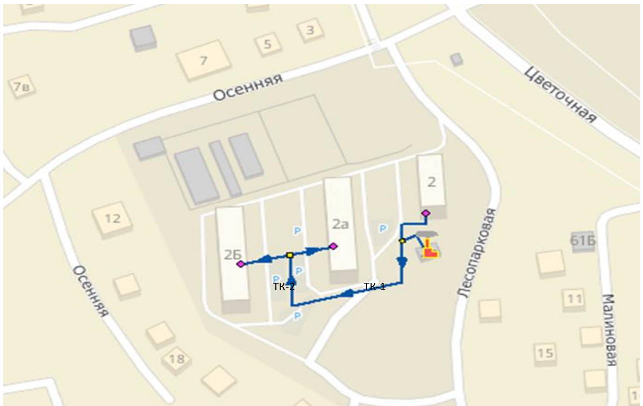
Рисунок 7 Схема тепловых сетей в контуре котельной «мкр. Ивушки» с обозначением тепловых камер
