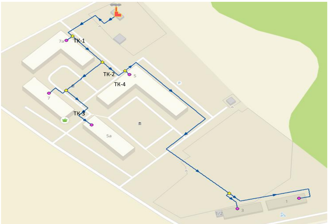
Рисунок 6 Схема тепловых сетей в контуре котельной «мкр. Кленовый» с обозначением тепловых камер
