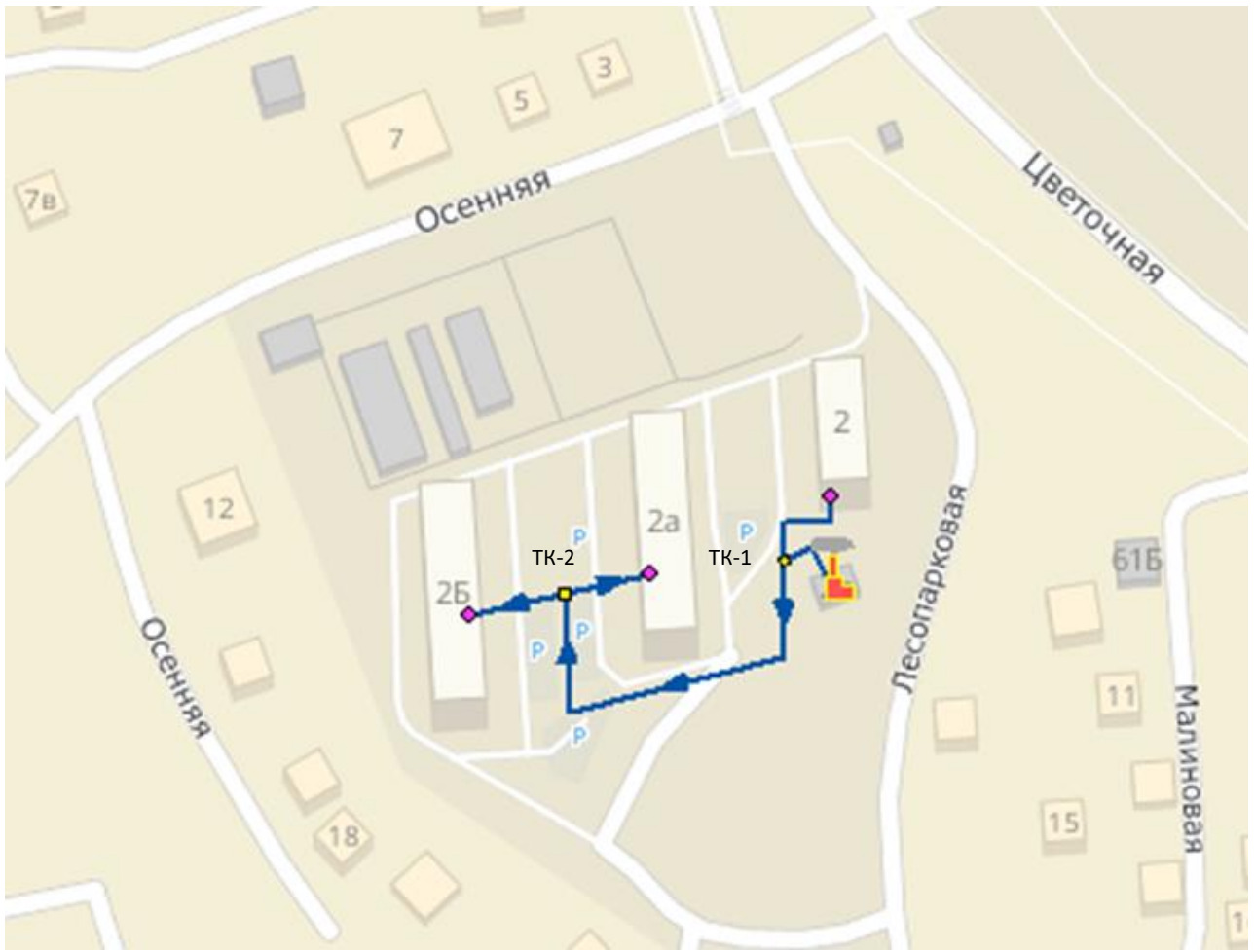
Рисунок 4-4. Схема тепловых сетей в контуре котельной «мкр. Ивушки» с обозначением тепловых камер
